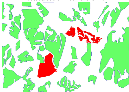
Figura 18: Capa con geometrías no válidas detectadas en Kosmo GIS 2.0
