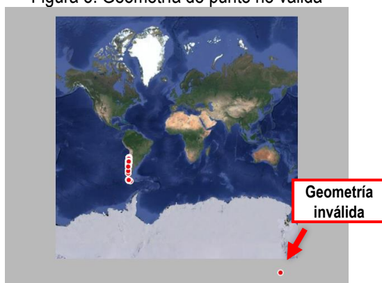
Figura 5: Geometría de punto no válida
