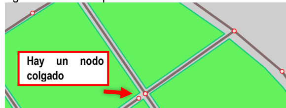
Figura 32: Líneas que no deben tener extremos sueltos
