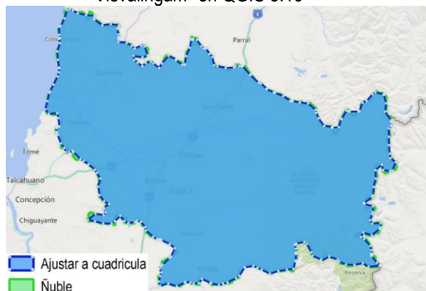
Figura 89: Ejemplo de simplificación usando el algoritmo de "Visvalingam" en QGIS 3.16
