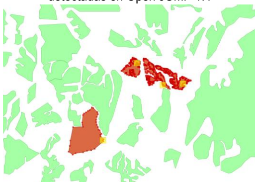
Figura 16: Capa con geometrías no válidas detectadas en Open JUMP 1.4
