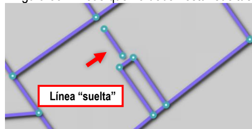
Figura 33: Líneas que no deben estar sueltas
